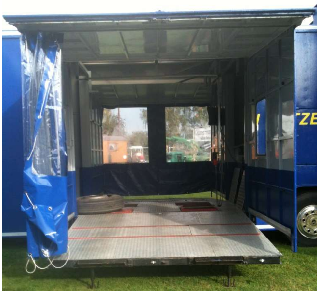
Arbeitsbereich Bremsen +Tachoprüfstand und Stoßdämpfertest
